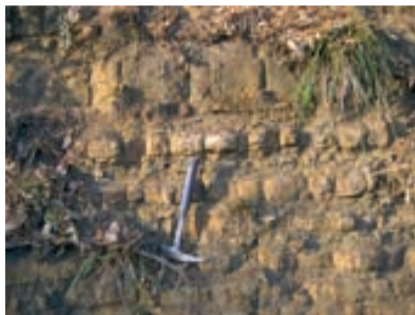
Fig. 6 - Affioramento di alternanza di arenarie peliti e siltiti lungo la strada asfaltata del monte Calvario.
